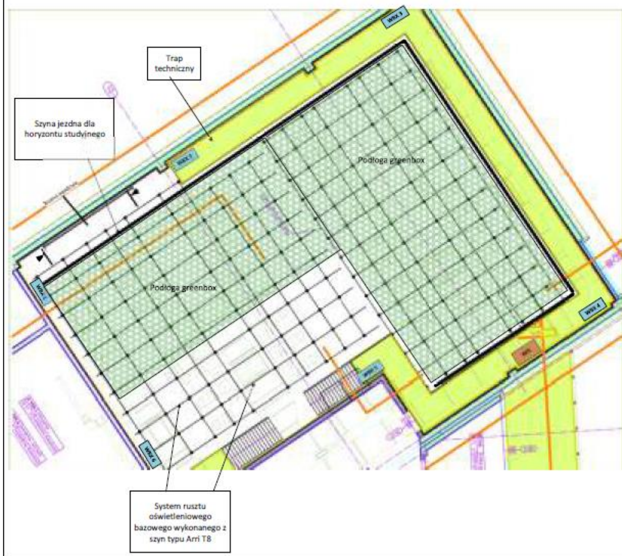
Rysunek 1. Rzut studnia z rozmieszczeniem urządzeń
